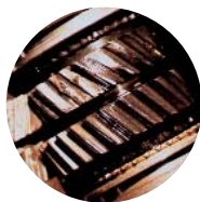
Getriebebeschaden durch abgenützte Zahnräder
